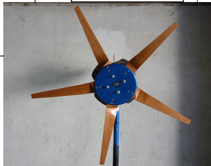
Disque arrière, pales côté extrados
