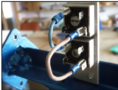
Pont de diode avec deux fils électriques. (pour relier les + et les -)
