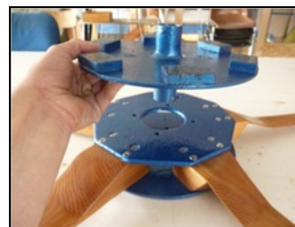
Orientation du rotor sur les pales
